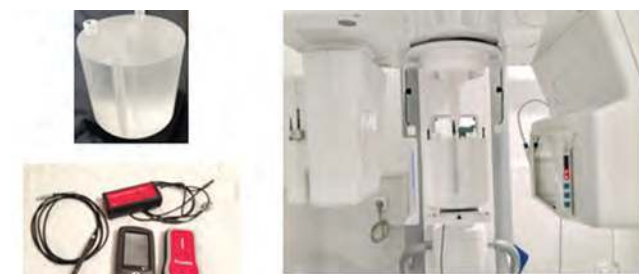
Mjerenje ozračenja dozimetrijskih veličina tijekom rada CBCT uređaja, pacijent je zamijenjen fantomom
